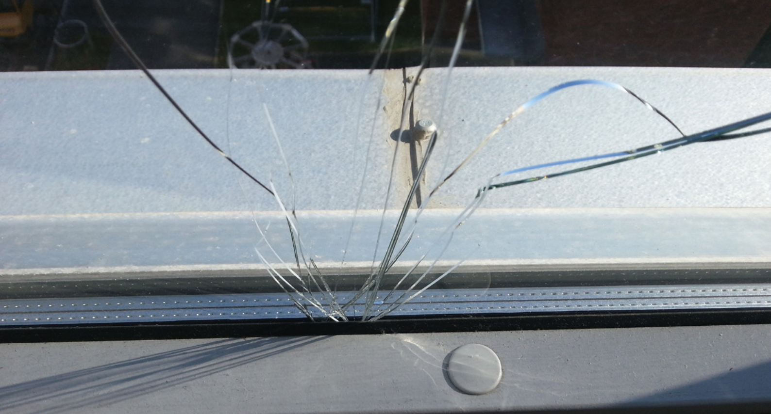
Bildet viser et karakteristisk mønster for termisk brudd i glass som ikke er herdet. Sprekken er vinkelrett ut fra skaden og sprer seg deretter i vifteform.
