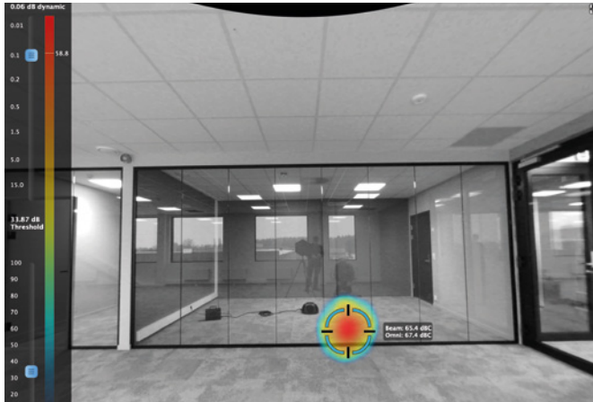
Test 1: Dobbel glassvegg med R'_w krav=44 dB. Målingene viser at den holder kravet selv om det er en liten lekkasje ved gulvet noe en også ser i «droppen» på øvre del av kurven.
