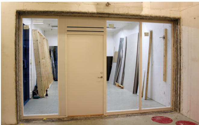
Test av fullskala glassvegg i lab.
