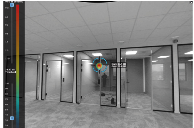
Test 2: Glassvegg i stillerom med R'_w krav=34 dB. Resultatet er innenfor kravet, men det er lekkasje i topp dørfelt som også sees på kurve ved at den flater ut. Selv om man er innfor kravet, kan det være hørbar lekkasje.
